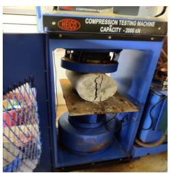
Fig.5 Tensile test
