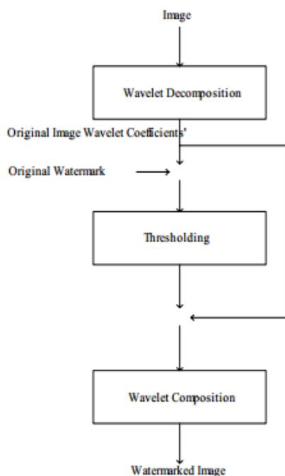
FIGURE II: HIGH LEVEL BLOCK OF THE SYSTEM
