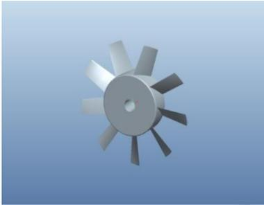
Fig. 2: Axial flow fan without ring
