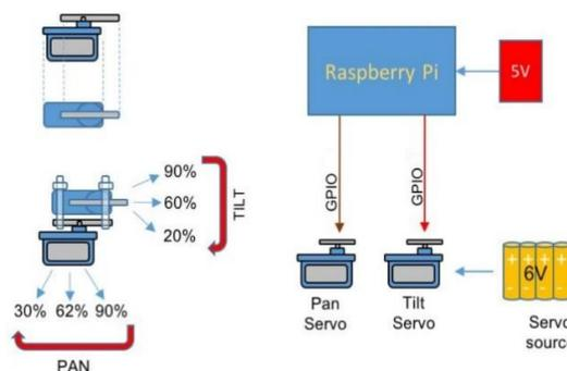
Fig. 9 Pantilt Servo Motor
