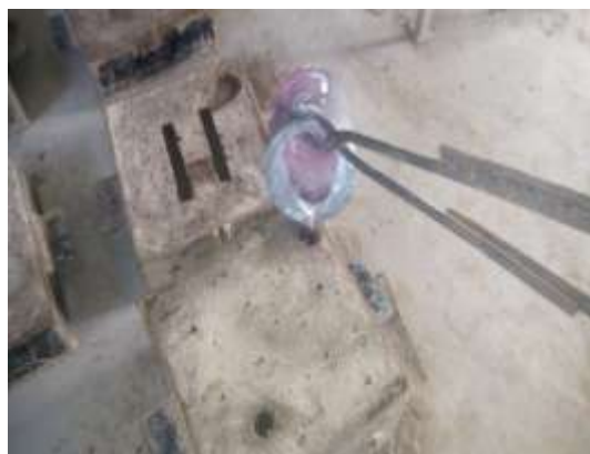
Fig 4.2: Pouring of Molten Metal to Die
