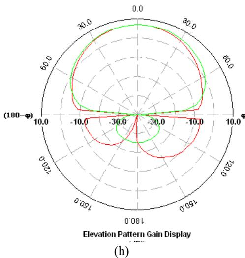
f=5.2(GHz), E-total, phi=90 (deg) ,F/B Ratio=32.03270692 dB
