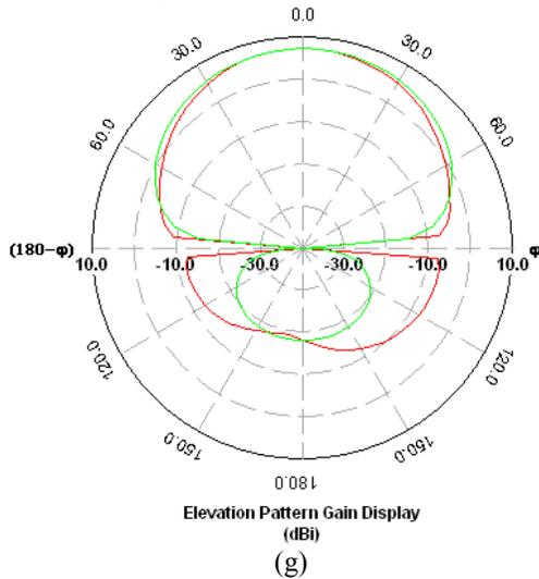
f=5.2(GHz), E-total, phi=0 (deg) ,F/B Ratio=32.03270692 dB
