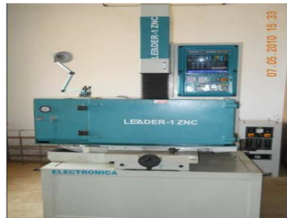
Fig.2.1 Die Sinker EDM Model: PS 50ZN
