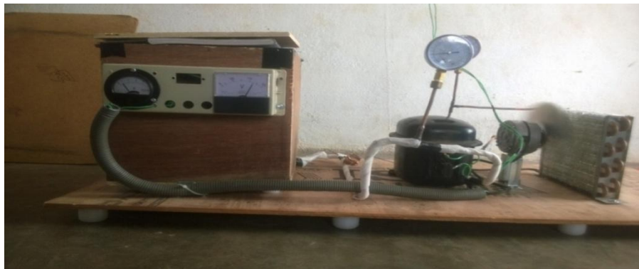
Fig .1 vapour compression test rig
