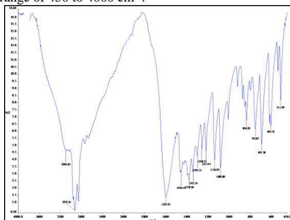
Figure5. FTIR Spectrum of Co:BaC<sub>4</sub>H<sub>4</sub>O<sub>6</sub> 0.05M
