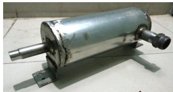
Fig. 5: Actual built silencer
