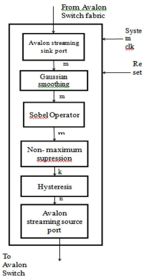
Figure 5. Edge detector block diagram.
