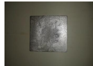
Fig 3.1 Aluminium+9% Al 2 O 3
