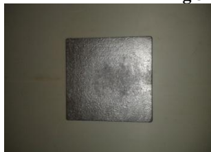
Fig 3.1 Aluminium+3% Al 2 O 3
