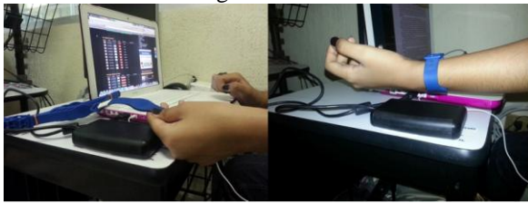
Fig. 5. Multi-ISO (OK 5553) RFID reader writing data on a bracelet tag (ISO 15693).
